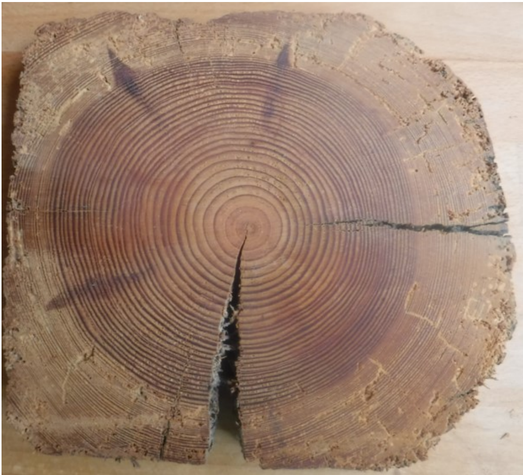
Bild 9: Beispielhafte Verteilung von Kern- und Splintholz an einem Kiefernsparren (Dachstuhl in Breitenfelde, Bj. Etwa 1880). Sichtbar sind auch die Fraßgänge von Nagekäfern, die nur das Splintholz befallen können.
