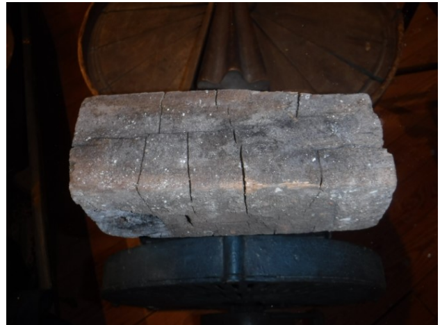
Bild 2: Alte Braunfäuleschäden an einem Lagerklotz
